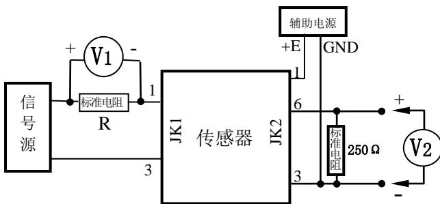
注：图中用标准电阻  $R$  把被测电流转化为交流电压，用  $V_1$  监测。用  $250\Omega$  标准电阻把电流输出转换为电压输出，用  $V_2$  测量。
